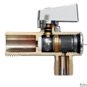
Řez rohovým ventilem
